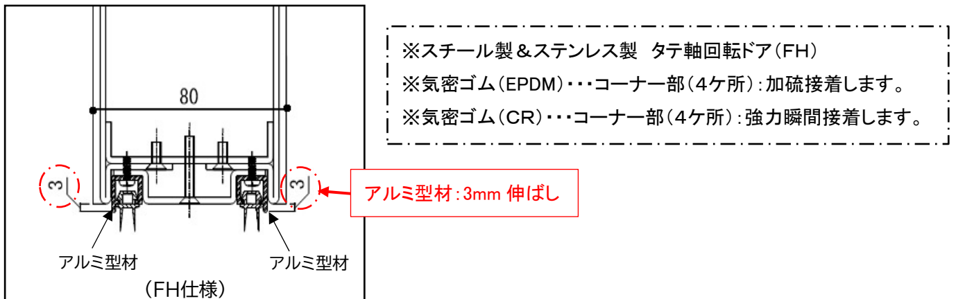
(図三) 気密ゴム用アルミ型材気密ゴム(CR・EPDM)収まり図
